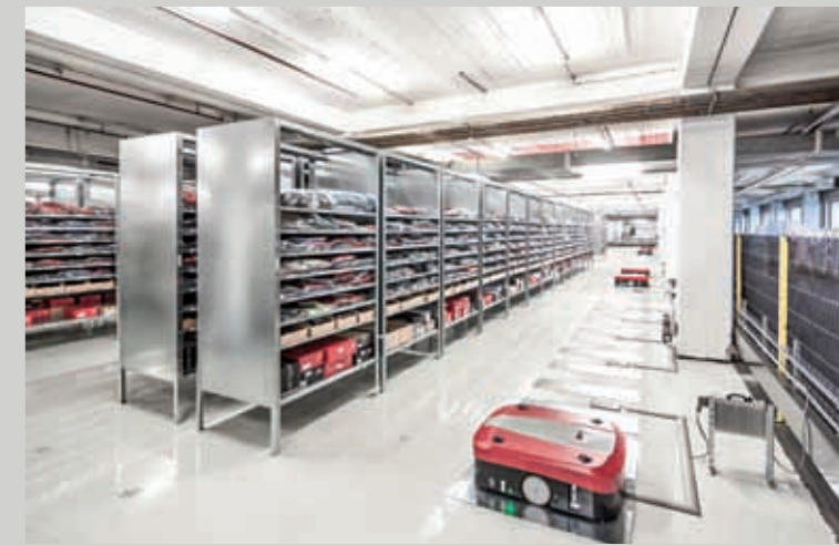
Zum Aufladen werden die Carrys automatisch auf induktive Ladematten am Boden geschickt.
