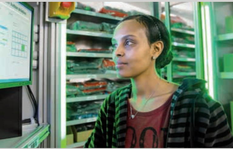
Im Stargate zeigen Computerbildschirm und Lichtpointer am Regal an, was in das Paket kommt.
