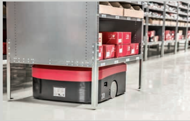
Der Carry rollt unter das Regal, bockt es auf und transportiert es zum Stargate.
